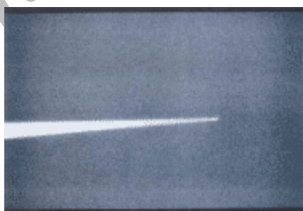
شکل 3 - تصویر یک نانوفیبر تولید شده به شیوه کشش لیزری
