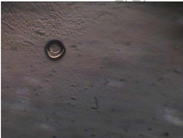
شکل ۵: سطح فیلم لایه نشانی شده بعد از عبور جریان و اندازه گیری ولتاژ هال. (طول عکس برابر با ۲۵۰ میکرومتر می باشد).
