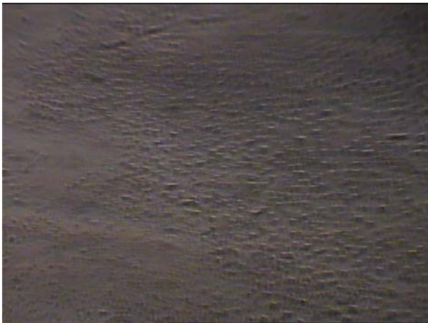
شکل ۴: سطح فیلم لایه نشانی شده قبل از عبور جریان (طول عکس برابر با ۲۵۰ میکرومتر می باشد).
