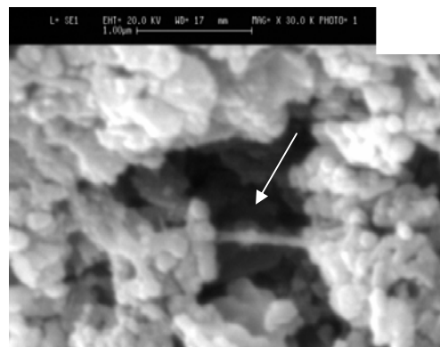
شکل ۵- الف و ب، تصاویر SEM از نحوه پل زدن CNTs در ساختار کامپوزیت
