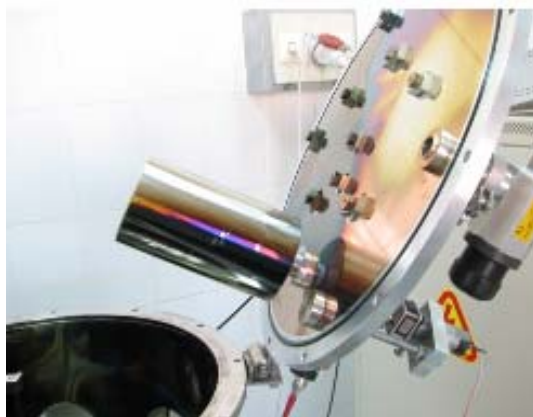
شکل ۳: تصویری از تانک نیتروژن چرخان که روی در محفظه نصب شده است.
