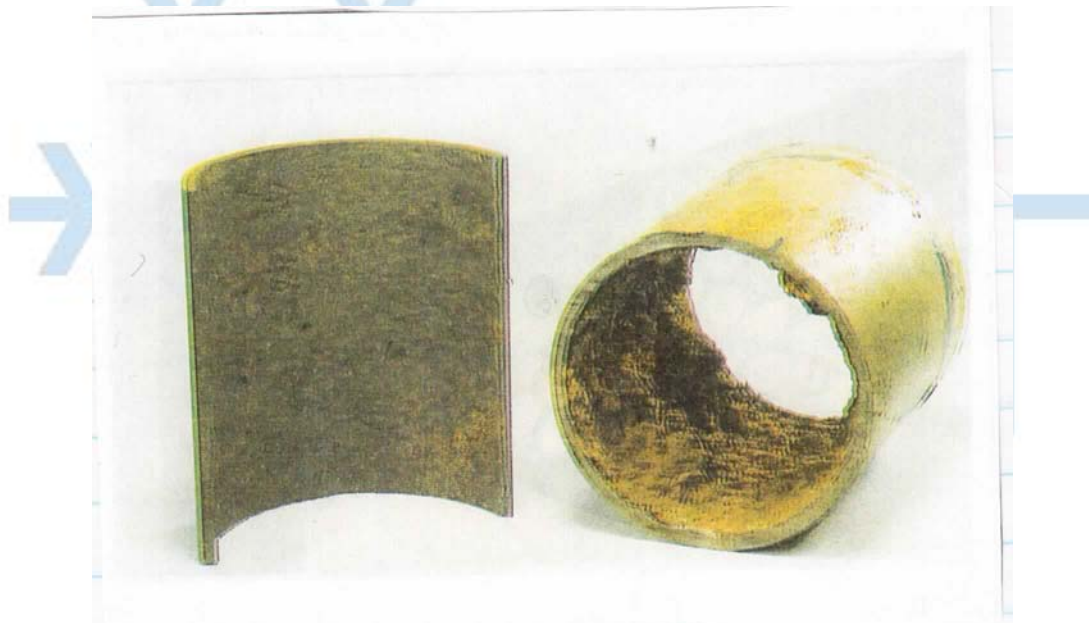
شکل ۱- خوردگی اکسیژنی لوله انتقال آب برج خنک کن
