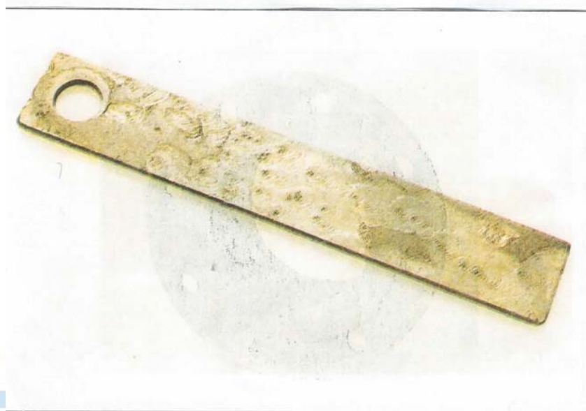
شکل ۲- خوردگی میکروبی کوپن خوردگی خنک کننده
