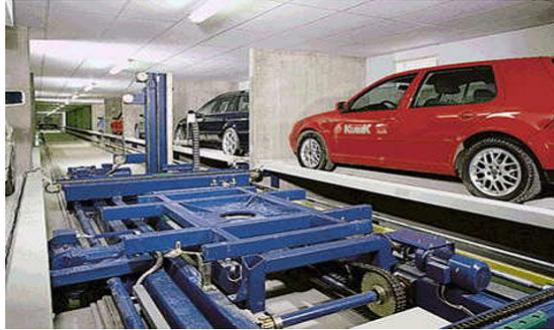
شکل (۹) خودروها در جهت مشخصی که در مسیر حرکت جابجا کننده است پارک می شوند.
