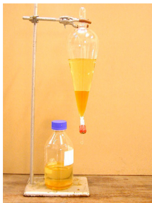
شکل ۲- جدا شدن فاز استری (بیودیزل) از فاز محتوی گلیسرین، فاز استری به دلیل دانسیته کمتر بالا قرار می گیرد.
