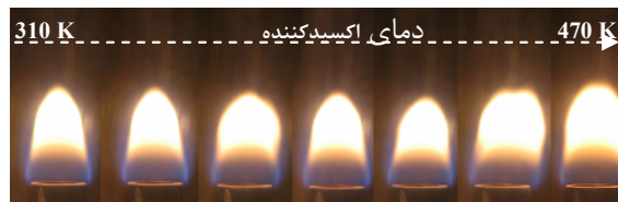
شکل ۵- تغییر شکل شعله نفوذی گاز طبیعی واکسیدکننده (80% Air+20% O 2 ) در شرایط (Q oxidizer = 36 l/min و Q f = 65ml/min)
