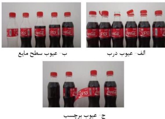
شکل (۵): عیب‌های رایج برای بازرسی بطری [۱]
