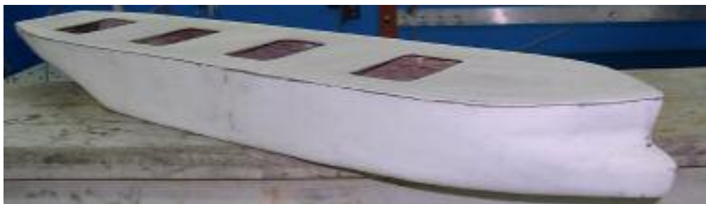
شکل ۳- مدل فایبرگلاس ساخته شده از روی مدل چوبی
