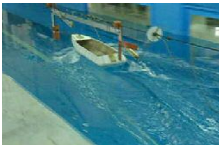
شکل ۲: عکسی از مدل در حال تست در حوضچه کشش
