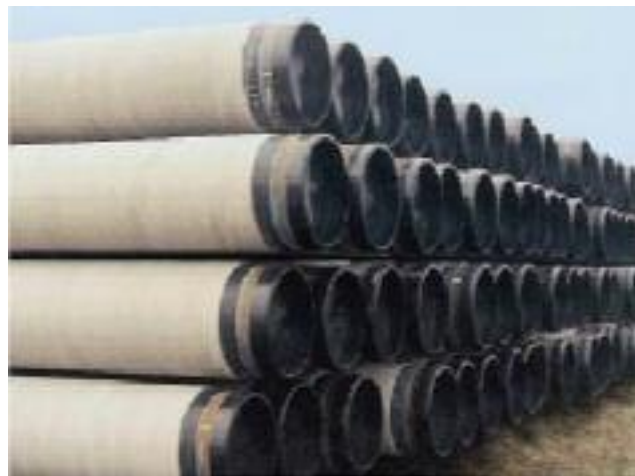
شکل (۶) نمونه ای از لوله های فولادی با Lining سیمانی [۱۴].
