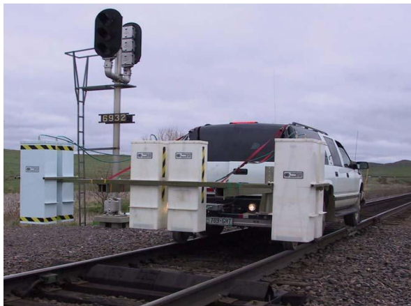
شکل-۲ سه جفت آنتن با فرکانس ۱ گیگاهرتز بر روی یک وسیله نقلیه
