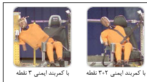
شکل ۱: تست تصادف برخورد از پهلو انجام شده توسط شرکت اتولویو [۳]
