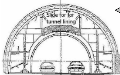
۳- نصب سپری محافظ ترافیک جهت اجرای عایقکاری و پوششهای جدید
