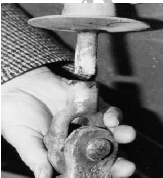
تصویر (۶) : شکست جدایشی مقره کامپوزیتی [۸]
