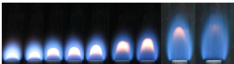
شکل 7- اثر پیش گرم بر رقیق سازی اکسیژن با CO_2 همراه با سوخت گاز طبیعی
