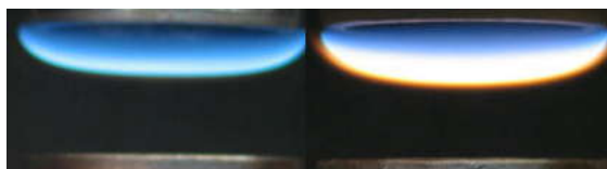
شکل 2- مقایسه بین شعله پروپان (سمت چپ) و گاز شهری (سمت راست). مقدار strain rate برابر 20 \text{ s}^{-1} ، سوخت شامل 30 درصد پروپان (گاز شهری)، V_F=1
