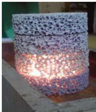
شکل 9- احتراق در محیط متخلخل به همراه پیش گرمایش با استفاده از SiC
