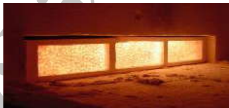
شکل 3- نمونه ای از مشعل متخلخل تابشی تخت
