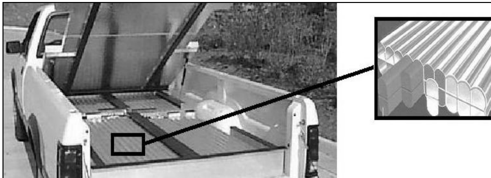
شکل 10 - نمونه‌ای از مخازن ای‌ان‌جی که در نوعی از خودروی داج به کار برده شده است [3].
