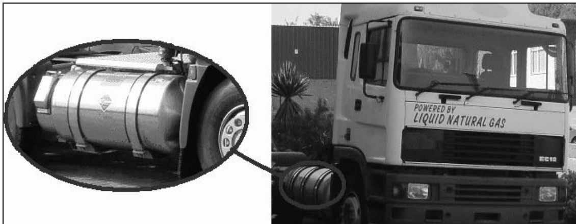
شکل 7- نمونه‌ای از مخازن اِلِان جی در یک خودروی سنگین.
