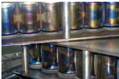
شکل ۴: پمپ های یونی متعلق به طیف سنج جرمی که نیاز به احیا دارند.
