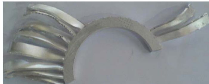
شکل ۳: نمونه یک طبقه شکسته شده از روتور پمپ توربومولکولار
