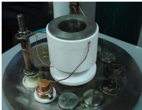
شکل ۳: تصویری از چشمه پلاسمای مورد آزمایش
