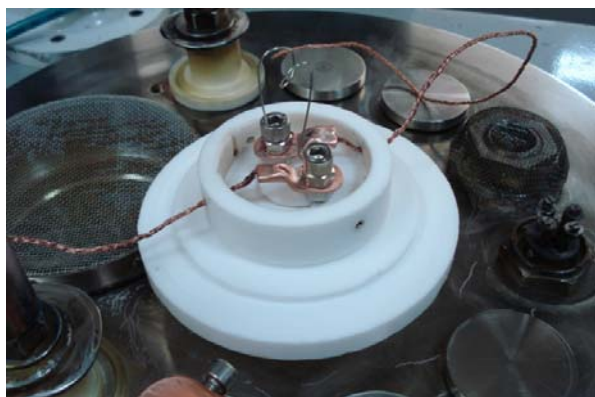
شکل ۲: کاتد و پایه نگهدارنده آن
