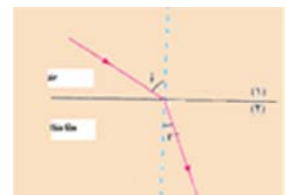
شکل (۱) i و r زاویه تابش و زاویه شکست در لایه نازک
