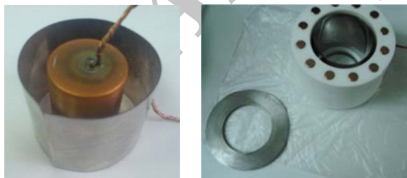
شکل ۲: اجزای زیرسامانه کندوپاش استوانه ای
