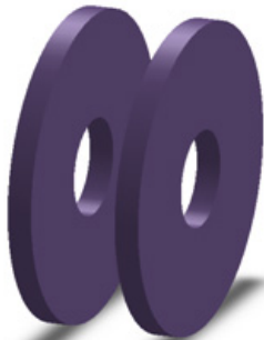
شکل ۲: نمای سه‌بعدی لنز روزنه‌ای دو المانی طراحی شده توسط نرم‌افزار Solid Work
