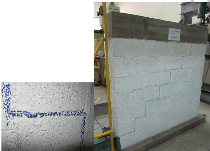
شکل (2): الگوی شکست دیوار در نمونه آزمایشگاهی
