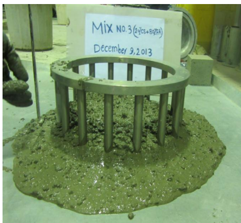
شکل 9- جایگزینی 20 درصد سرباره
