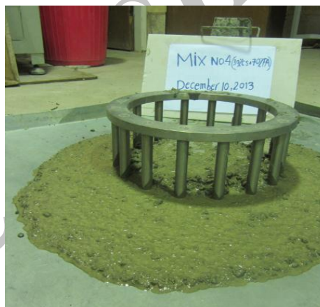
شکل 8- جایگزینی 30 درصد سرباره
