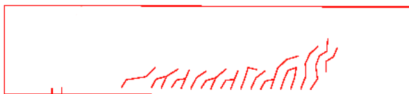
شکل 9- شکل ترک خوردگی تحلیل عددی
