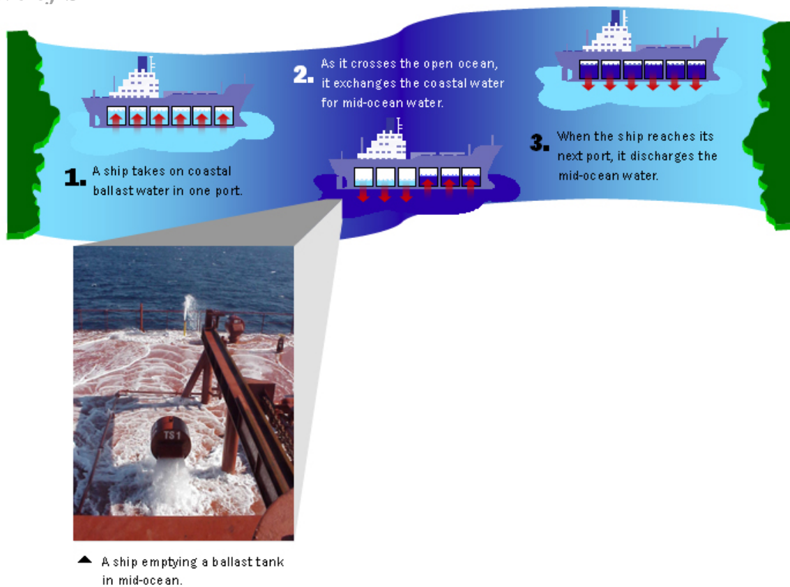
شکل ۴ - تعویض آب بالاست در دریای آزاد
