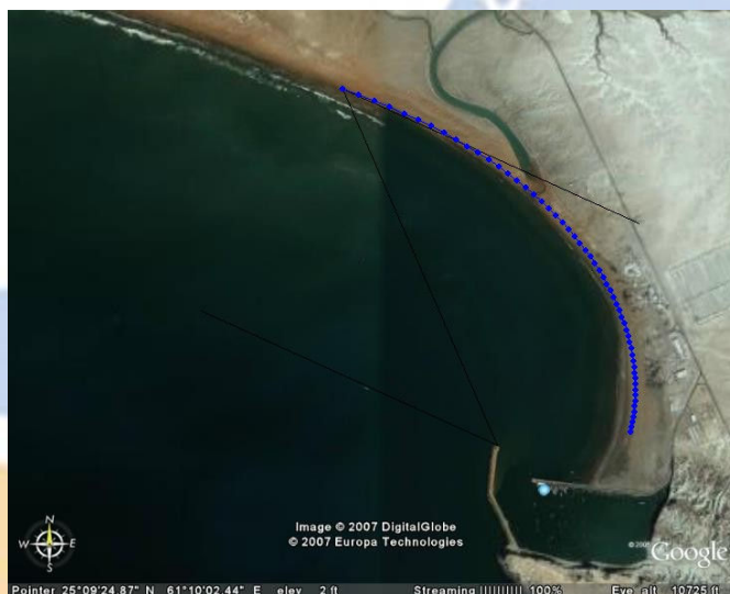
شکل ۳: منحنی تعادل استاتیکی خلیج و مقایسه آن با شکل واقعی خلیج
