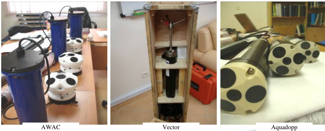
شکل ۲- سرعت سنج های داپلری مورد استفاده در اندازه گیری خلیج چابهار
