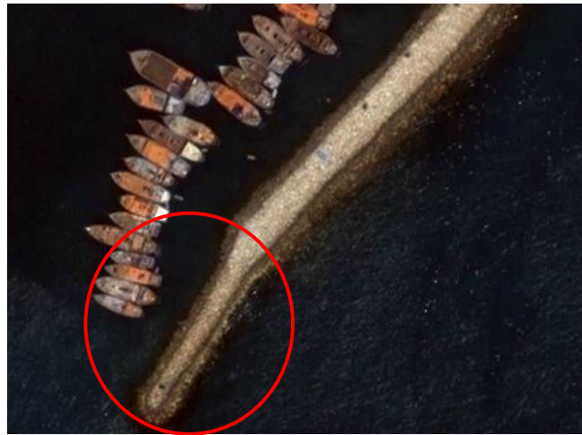
شکل ۱: عدم تناسب ۸۰ متر انتهایی اضافه شده با مقاطع قبلی
