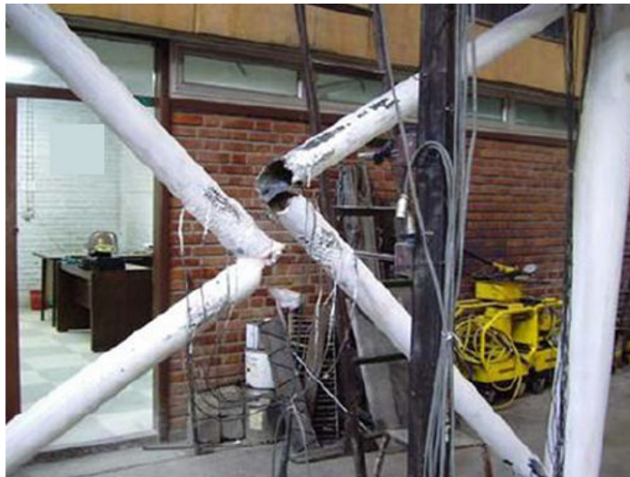
شکل ۹. شکست اتصال در قاب شماره ۲ (Honarvar و همکاران (۲۰۰۸) [2])
