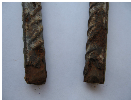
شکل 6: وضعیت خوردگی میلگردهای داخل نمونه های سیمان نوع 5 با پوشش 3/5 سانتیمتر و نسبت آب به سیمان 0/4 در شرایط جزر و مدی
