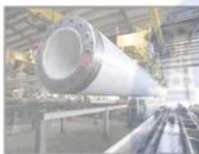
شکل ۱۱) بلند کردن شمع از نیمه پایینی قالب و جابجایی آن (راست به چپ)
