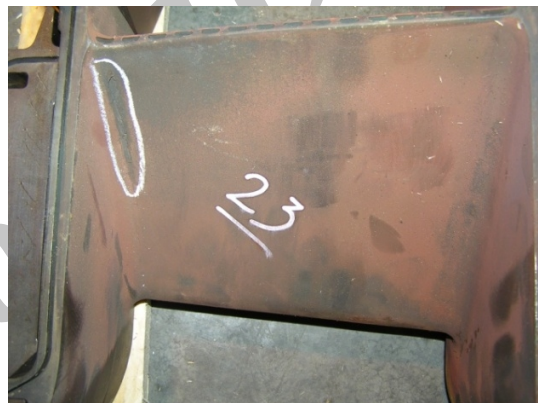
شکل 5-1: نازل آسیب دیده واحد 5
