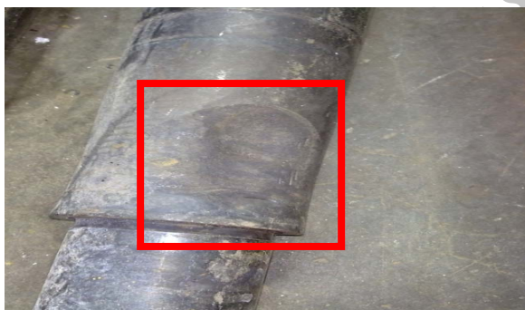
شکل ۱- استم باز شده در اولین دوره تعمیرات
