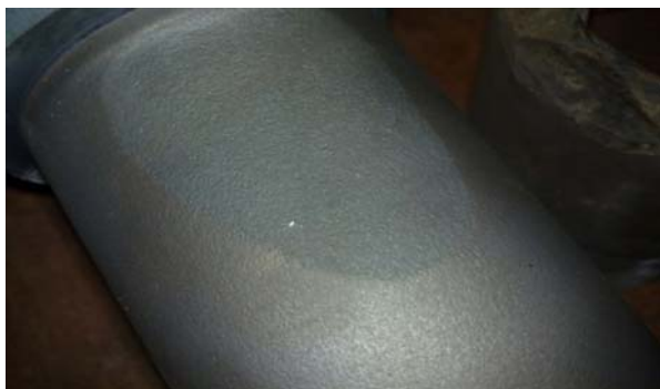
شکل ۲- استم تعویض شده به علت خوردگی بالا در دومین دوره تعمیرات
