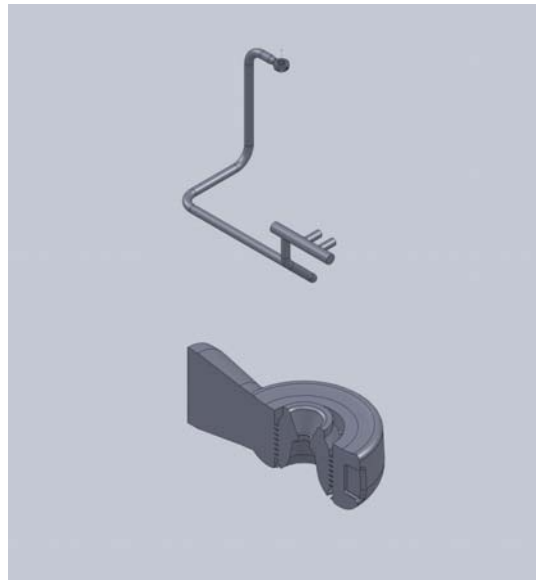
شکل ۴- نمایش سه بعدی از مسیر بخار در شیر و مسیر
