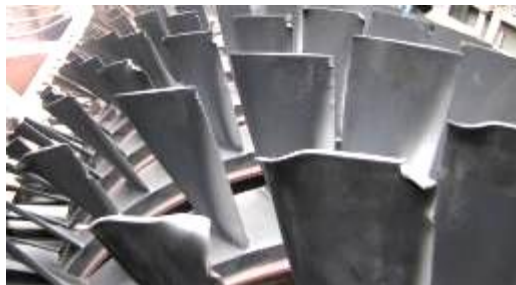
شکل (۴): آسیب پره های متحرک کمپرسور ناشی از برخورد تکه شکسته مرحله اول.
