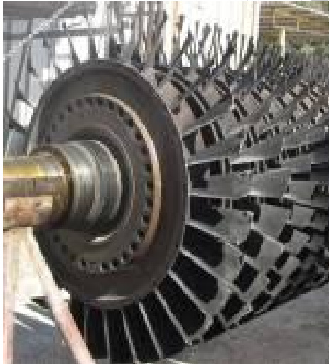
شکل (۱): روتور کمپرسور حادثه دیده.
