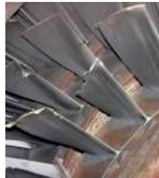
شکل (۲): نمایی از شکست پره ردیف اول کمپرسور.
