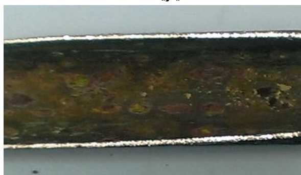
شکل 13: نمای نهایی درون لوله پس از اسید شویی توسط HCl 5%
