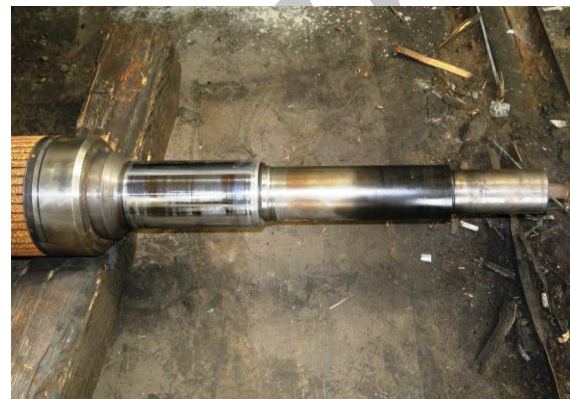
شکل ۵: قسمت حرارت دیده شفت
