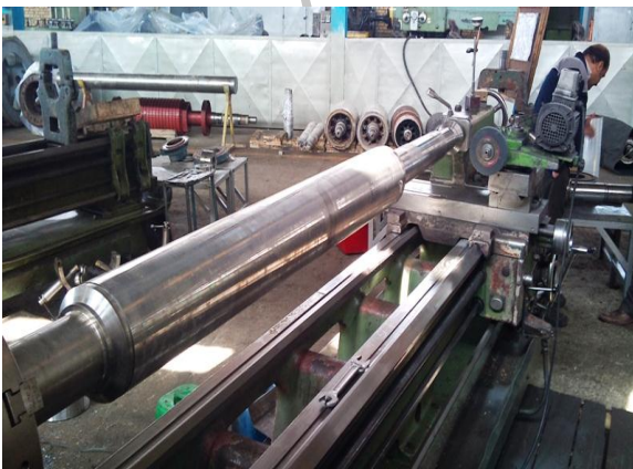
شکل ۶: شافت در حال تراشکاری
