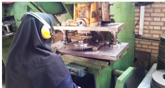
شکل ۷: پانچ و برش ورقه های هسته
