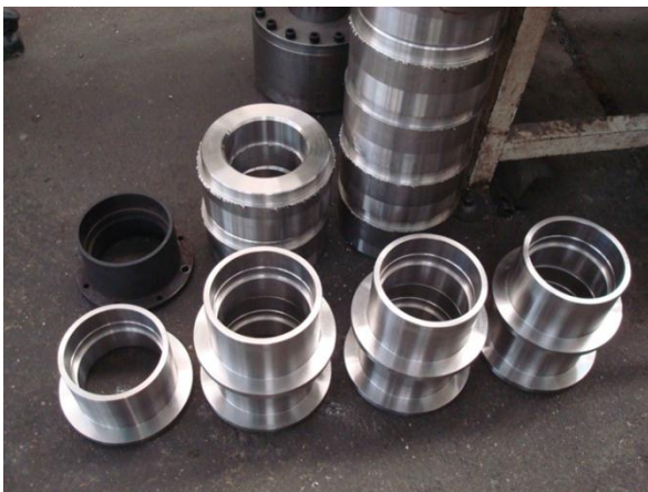
شکل ۲۵- تراشکاری اولیه قطعات حلقه ورودی و قبل از سوراخکاری و پرداخت نهایی
