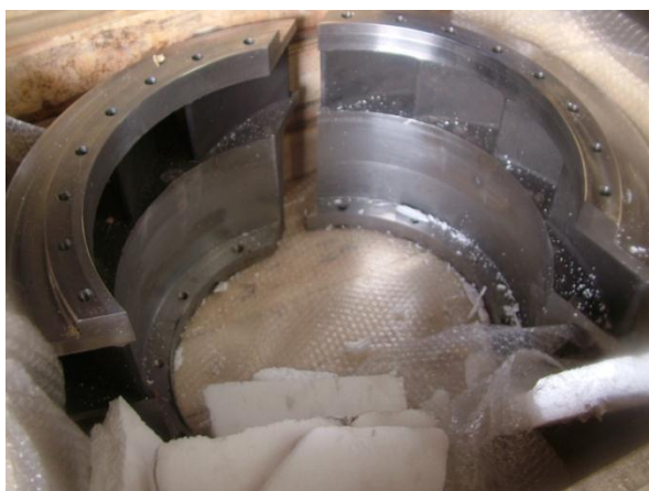
شکل ۲۰: دیفیوزر ساخته شده از روی مدل ارائه شده پس از اتمام تراشکاری قطعه در دستگاه تراش اتوماتیک
