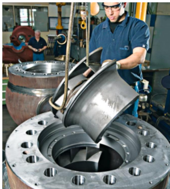
شکل ۱۷: نصب دیفیوزر پمپ در داخل پوسته ، سه قطعه به صورت جداگانه در محل نصب می شود.
