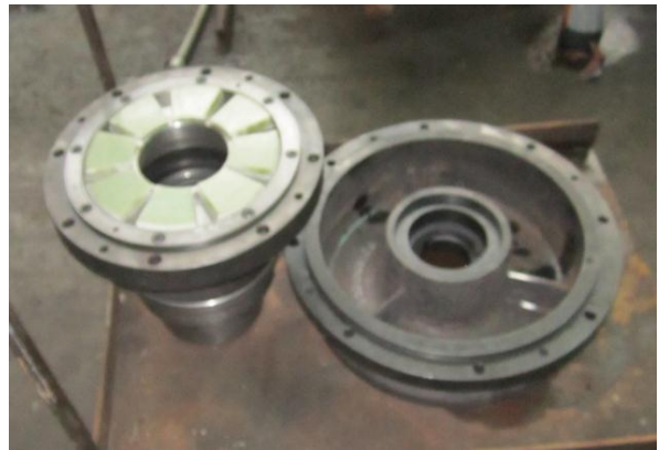
شکل ۱۱: نصب کفشک های تراست با نمونه جدید بر روی قطعات پمپ
