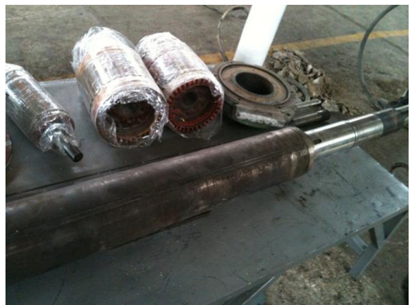
شکل ۱۲: دمونتاز شفت از روتور معیوب پمپ گردش آب بویلر و آماده سازی ساخت روتور جدید
