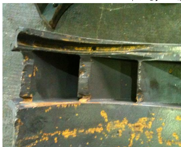
شکل ۱۸: آسیب دیدگی دیفیوزر پمپ در اثر برخورد پروانه و خرابی نشیمنگاه ها و محل اتصال دیفیوزر به پوسته پمپ
