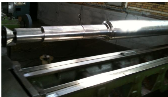
شکل ۱۳: تراشکاری اولیه شفت روتور پمپ و آماده سازی برای تنش زدایی ز شفت جهت تراش نهایی
