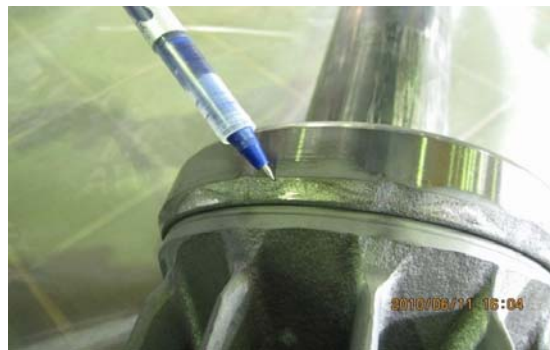
(شکل 2)- خوردگی سطح آبنند دیسک
