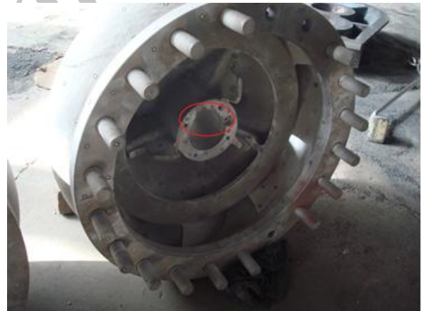
شکل 4: دیفیوزر نمونه ارسال شده به منظور اسکن و نقشه برداری (همانطور که در عکس ها مشخص است محل عبور شافت بر اثر خوردگی به صورت بیضی شکل تبدیل شده است
