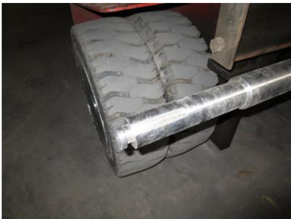
شکل 31: محل بسته شدن قفل کن روی شافت
