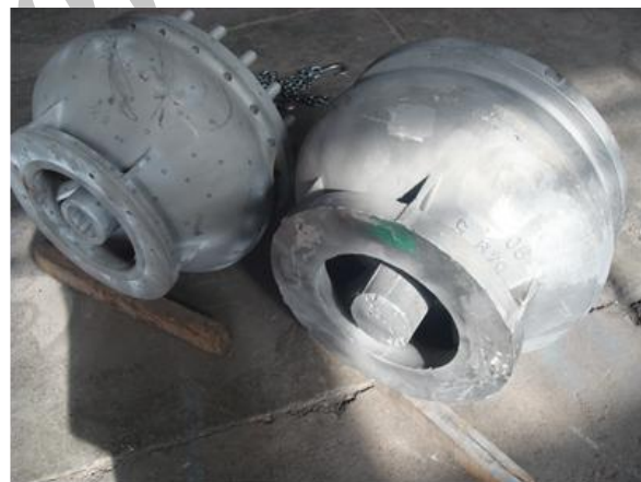
شکل 18: دیفیوزر خام ریخته گری شده در کنار نمونه اصلی آن
