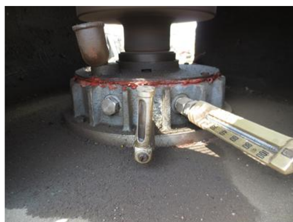
شکل 27: محفظه روغن ساخته شده که در محل بسته شده است و در حال بهره برداری می باشد
