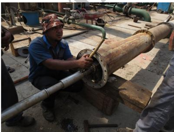
شکل 37: نحوه جازدن بوش روی قفل کن
