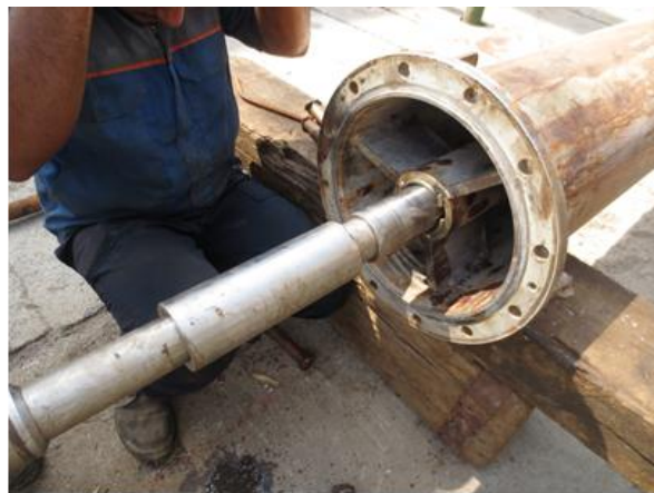
شکل 38: بوش قفل کن جا زده شده (قفل کن در زیر این بوش قرار دارد)
