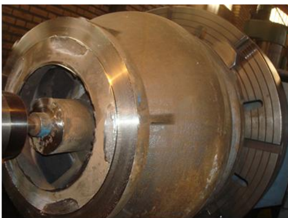
شکل 20: دیفیوزر ساخته شده در حال تراشکاری و سایز شدن
