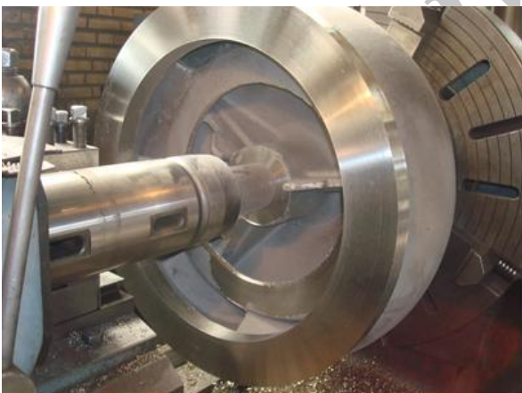
شکل 21: دیفیوزر ساخته شده در حال تراشکاری و سایز شدن
