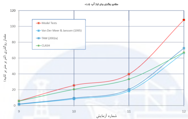
شکل 5) نتایج محاسبات مقدار روگذری در مقایسه با نتایج مدل آزمایشگاهی برای مقطع موج شکن غربی
