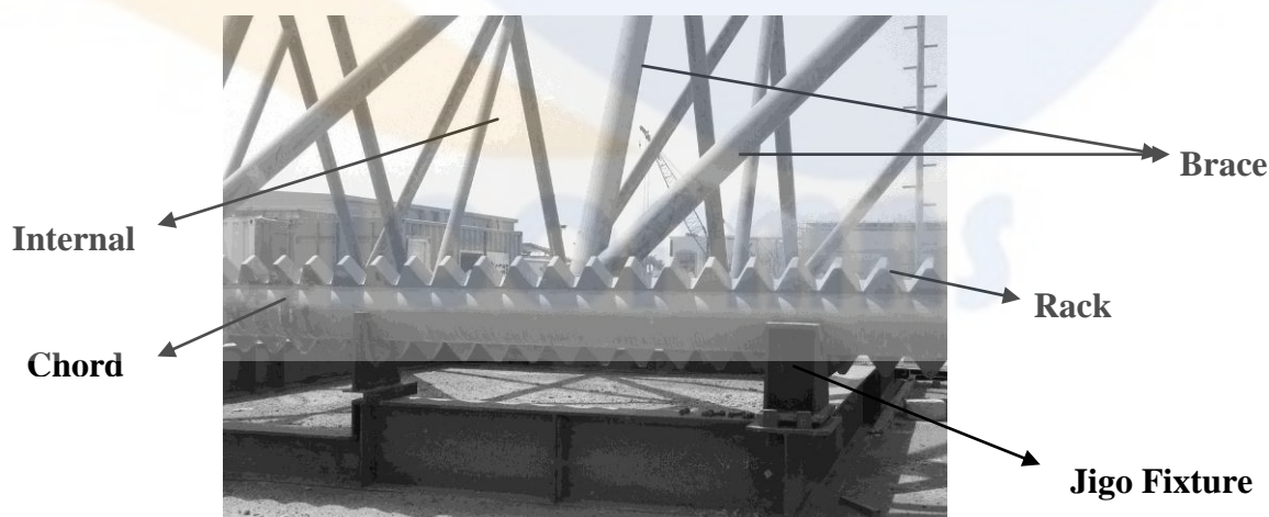
شکل ۱) نمایی از سرهم بندی پایه بر روی Jigo fixture
