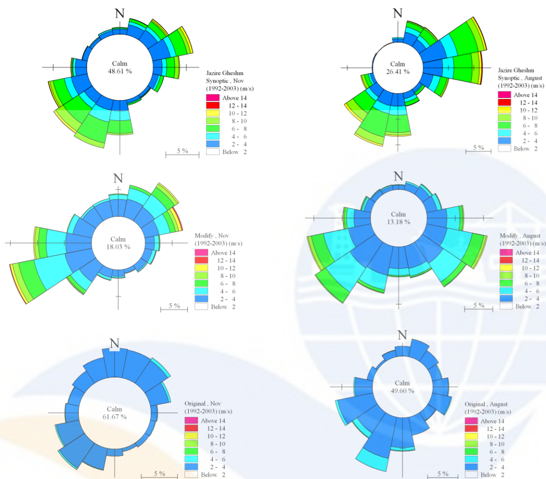
شکل 15- مقایسه گلبادهای ماهانه سینوپتیکی و مدل های ECMWF (Original و Modified) ماه های آگوست و نوامبر ایستگاه جزیره قشم
