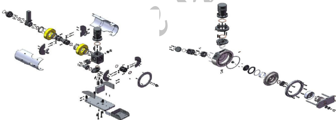
شکل ۸: نقشه انفجاری از قطعات بکار رفته در تفنگ الکترونی
