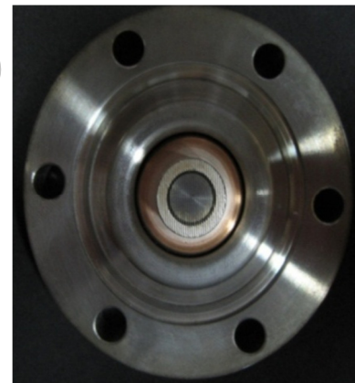
شکل ۴: کاتد مورد استفاده در تفنگ الکترونی
