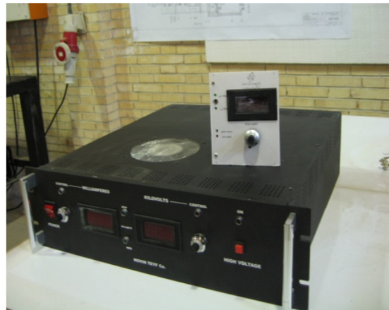
شکل ۹: دستگاه منبع تغذیه ولتاژ بالا و تغذیه مگنتها
