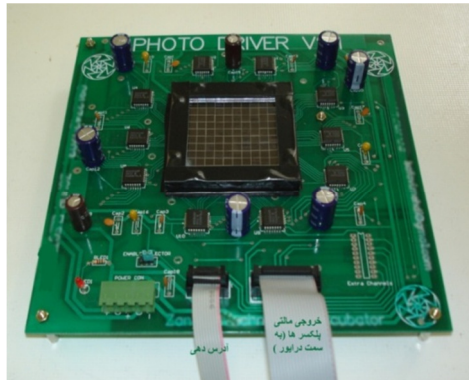
شکل ۴: برد حسگر شامل شبکه ی فوتودیودی و مالتی پلکسرها
